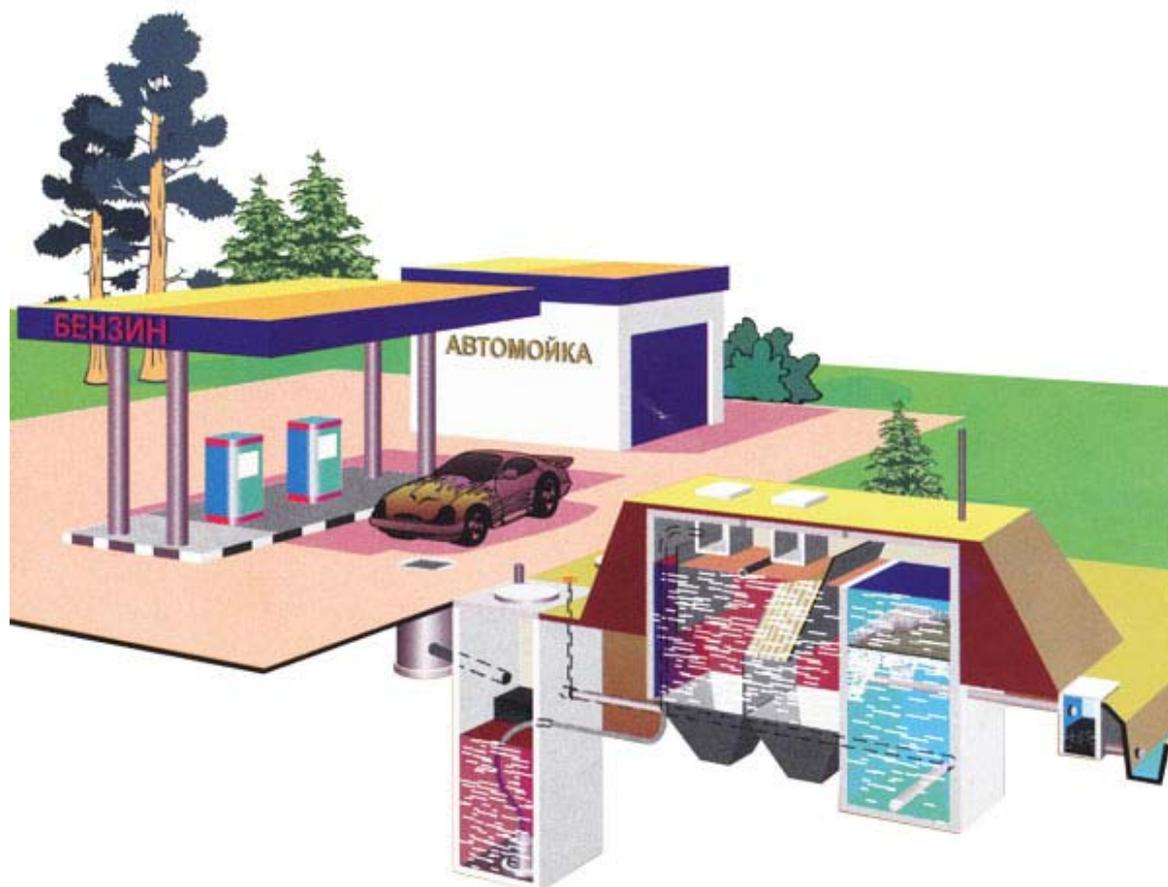
**Преимущества установки:** Установка полной заводской готовности (поставляется в течении 2-4 недель), простота монтажа и обслуживания, высокая экономическая и гигиеническая эффективность, самотечный отвод очищенных сточных вод, возможность использования при высоком уровне грунтовых вод.
