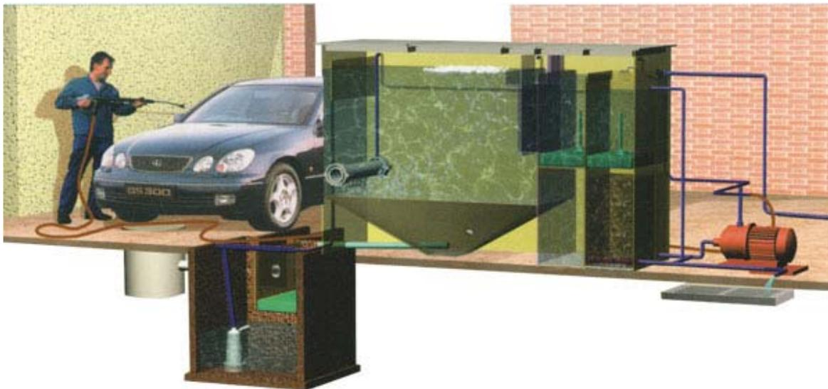
**Преимущества установки:** Совмещение в установке функций приема, очистки и подачи воды на мойку. Надежность технологического процесса и применяемого оборудования. Отсутствие потребности в реагентах. Очистка избыточной воды до содержания загрязнений, позволяющих осуществлять ее сброс без санитарных и экологических ограничений. Компактность и низкая стоимость.
